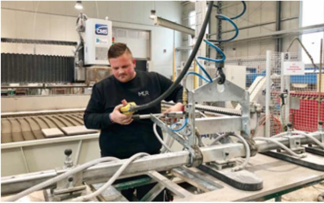
Produktionsexperte Marcel vor der 2016 installierten 5-Achsen-Wasserstrahlanlage »Aquatec 5040 Twin« mit Doppeltisch
